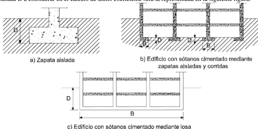
Figura N° 41.- Profundidad D a considerar en la determinación de la presión de hundimiento
